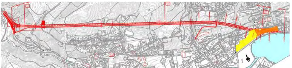
Abbildung 6: Situation «Variante N+», Stand Generelles Projekt 2022 (temporärer Flächenbedarf gelb, permanenter Flächenbedarf orange)
