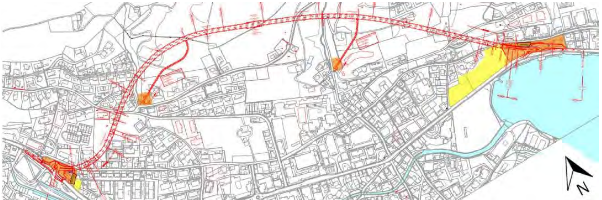
Abbildung 5: Situation «Variante 10a», Stand Variantenvergleich 2022 (temporärer Flächenbedarf gelb, permanenter Flächenbedarf orange)
